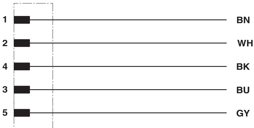
Kontaktbelegung des M12-Steckers
