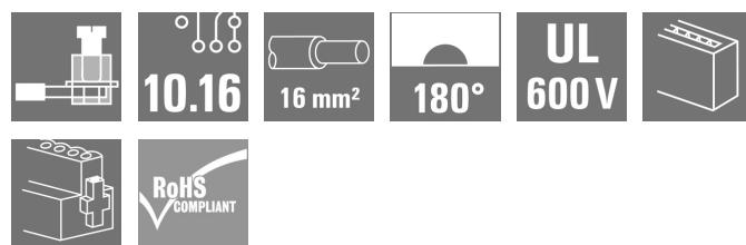
180°-Buchsenstecker im Raster 10.16 für IT-Netze. Erfüllt die Forderungen der UL1059 600 V Class C. In Verbindung mit der Stiftleiste SU 10.16 IT mit voreilendem Kontakt.
