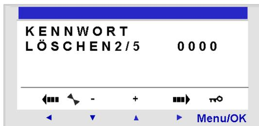
Wenn das Kennwort **5** Mal in Folge falsch eingegeben wird, wird die Sicherheitsfunktion während 30 Minuten gesperrt.
