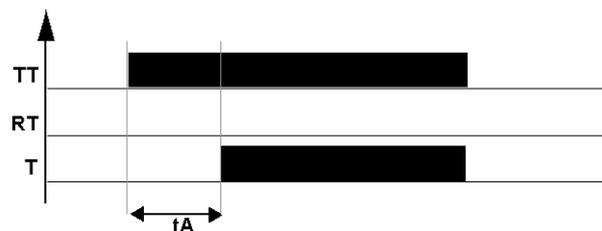
Typ a: **Aktiv, zum Starten/Stoppen drücken**. Das folgende Diagramm zeigt die Funktionsweise des Timer-Typs a:
