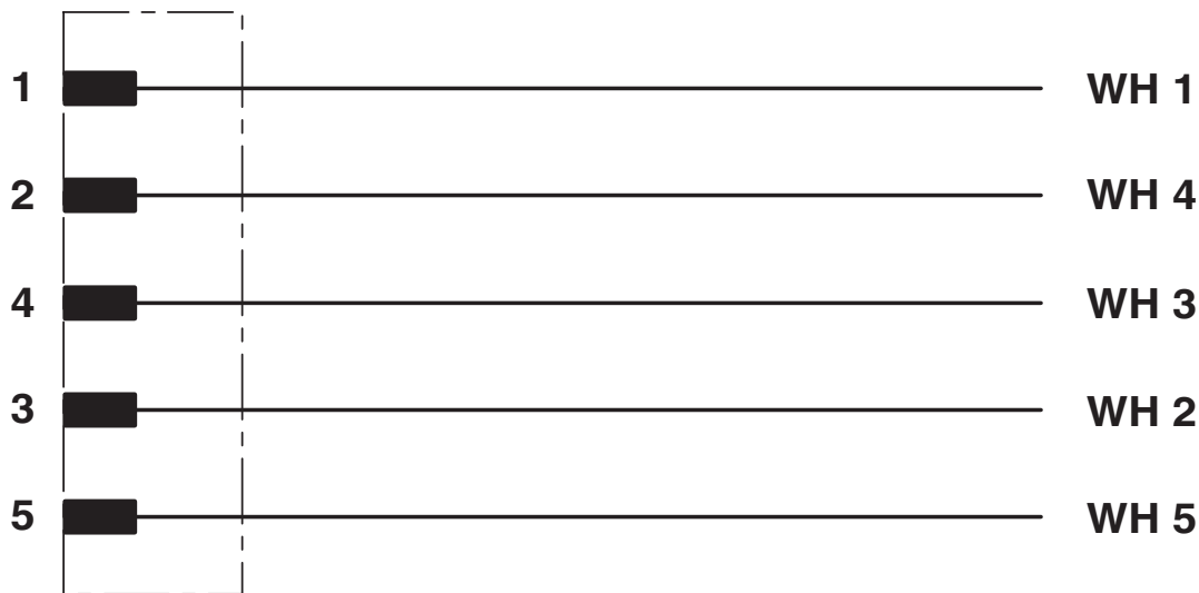
Ocupación de contactos del conector macho M12
