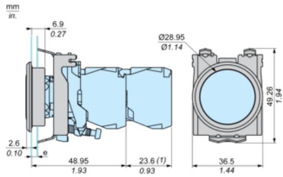
e: Spessore fissaggio: da 1,2 a 2,8 mm / da 0,05 a 0,11 in.
