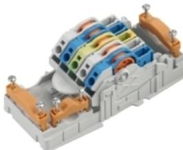
Energieverteilung mit ungeschnittener Leitung mit Leitungsquerschnitten von 1,5 bis 6mm<sup>2</sup>. Einspeisung / T-Abzweig über PUSH IN Anschluss 0,5 bis 10 mm<sup>2</sup> und/oder Steckanschluss 0,5 bis 4mm<sup>2</sup>. Farbige Markierungen ermöglichen eine eindeutige Leiterzuordnung.
