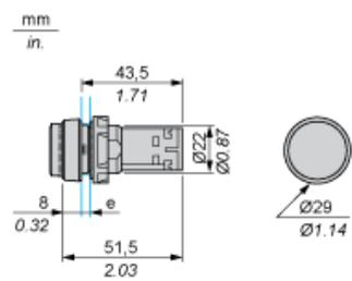
e Spessore pannello di supporto: da 1 a 6 mm/da 0.4 a 0.24 in. (metallo), da 2 a 6 mm/da 0.8 a 0.24 in. (plastica).
