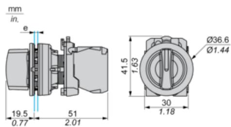
e: Espesor de sujeción: de 1 a 6 mm (de 0,04 a 0,24 in)
