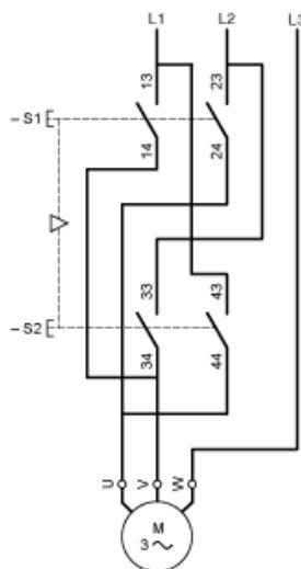
En combinaison avec bloc d'isolement tripolaire XACS399 ou XACS3991, représenté en position inactive (en attente de mise sous tension de la station), équipé d'un opérateur d'arrêt d'urgence à action de déclenchement de verrouillage par clé.
