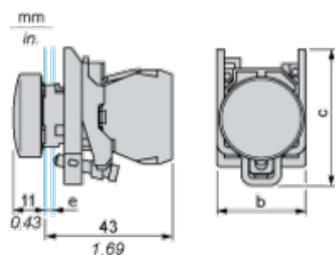
e: espesor de sujeción: de 1 a 6 mm (de 0.04 a 0.24 in)
