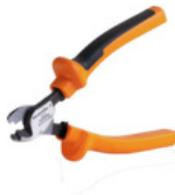
Schneidwerkzeuge für Leiter bis 8 mm, 12 mm, 14 mm bzw. 22 mm Außendurchmesser. Die spezielle Schneidengeometrie ermöglicht ein quetschfreies Schneiden von Kupfer- und Aluminiumleitern mit minimalen Handkräften. Zudem besitzen die Schneidwerkzeuge (KT 8 bis KT 22) VDE- und GS-geprüfte Schutzisolationen bis 1.000 V gemäß EN/IEC 60900.
