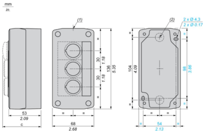
(1) 2 prerrecortes para prensaestopas Pg 13.5, capacidad máxima 12 mm (0.47 in)
