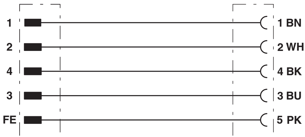
Kontaktbelegung der M12-Stecker/Buchse
