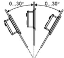
Quando si installa questo prodotto in posizione inclinata con angolo maggiore di 30°, la temperatura ambiente non deve superare 40 °C (104 °F). Potrebbe essere necessario l'uso di aria di raffreddamento forzata (ventilatori, A/C) per assicurare che la temperatura ambiente sia al massimo 40°C (massimo 104°F).
