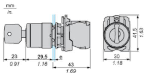
e: espesor de sujeción: de 1 a 6 mm (de 0.04 a 0.24 in)
