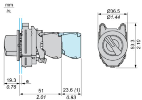
e : épaisseur du dispositif de serrage : 1 à 6 mm / 0,04 à 0,24 po.
