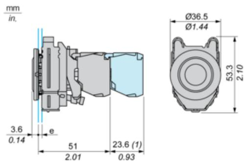
e: Espesor de sujeción: de 1 a 6 mm (de 0,04 a 0,24 in.)
