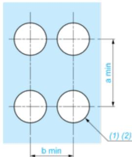
(1) Durchmesser auf fertiger Schalttafel oder Montagehalterung
