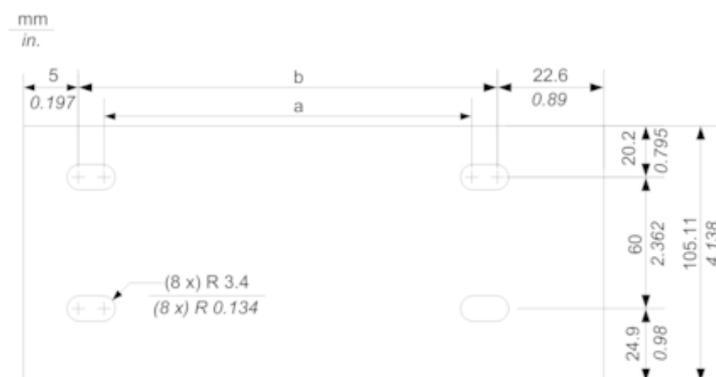
NOTE: Vous pouvez utiliser des vis M4, M5, M6 ou UNC #6 dans les trous de fixation.
