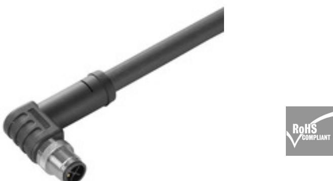
Ihre Geräte in der Peripherie sollen mit großer Leistung versorgt werden. Mit unseren neuen M12-Steckverbindern sind mehr als 250 V und 2 A problemlos möglich. Die kompakten A-, K-, L-, S- und T-codierten M12-Steckverbindern sind auf die Übertragung von bis zu 630 V AC bzw. 60 V DC und 12 A ausgelegt.
