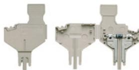
Der Bauelementestecker dient dem integrieren einer elektrischen Komponente in einer Trennreihenklemme. Nach dem Einlöten der jeweiligen Komponente lässt sich der Stecker in den Trennbereich unserer Reihenklemmen integrieren und ändert dadurch die Trennklemme zu einer Reihenklemme mit integrierter elektronischer Komponente.
