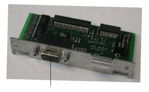
Das Optionsmodul wird nach dem Einbau automatisch von der Steuerung erkannt. Konfigurieren Sie es anschließend über die Steuerungskonfiguration in EcoStruxure Machine Expert Logic Builder.
