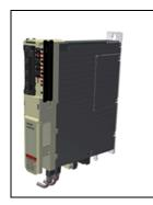
Das Lexium 62 Connection Module versorgt die Lexium 62 ILMs über ein Hybridkabel bzw. Leistungskabel (Daisy-Chain-Verkabelung) mit Gleichspannung aus dem Zwischenkreis. Zusätzlich stellt das Lexium 62 Connection Module die Inverter Enable- und Sercos-Schnittstelle zur Verfügung.
