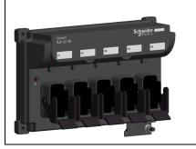
Die Lexium 62 Distribution Box ist das Bindeglied zwischen Lexium 62 Connection Module und Lexium 62 ILM. Je nach Anzahl der Antriebe können wahlweise 1 bis 4 Lexium 62 ILMs bzw. Daisy Chain-Stränge angeschlossen werden. Beim Betrieb von mehr als vier Antrieben erweitern Sie das System einfach durch ein oder mehrere Lexium 62 Distribution Box.
