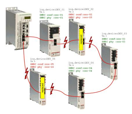
Nach dem physischen Austausch der Geräte muss die Maschine neu gestartet werden. Damit die FDR-Schnittstelle der Steuerung startet, muss der Parameter FDRStartMode auf Start/1 oder Phase start-up/2 und der Parameter FDRConfirmationMode auf by display / 0. gesetzt sein.
