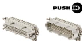
Die Push-In Anschlussstechnologie ist eine Direktstecktechnik. Der vorbehandelte Leiter kann ohne zusätzliche Hilfsmittel direkt in die Leiteranschluss ebene gesteckt werden.
