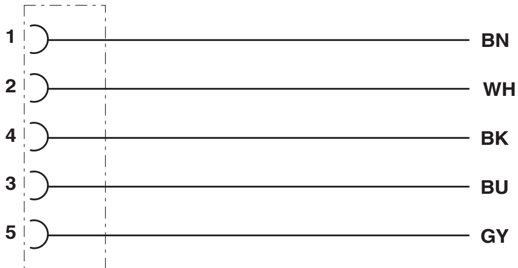
Kontaktbelegung der M12-Buchse
