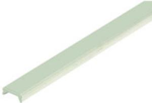
Abdeckprofile sorgen für den Schutz vor äußeren Einwirkungen auf Funktionsbereiche der Reihenklemmen oder in Kombination mit unseren Halteplatten für die gesamte Klemmleiste. Sie bieten Schutz gegen elektrischen Schlag durch das unbeabsichtigte Berühren betriebsbedingt oder fehlerbedingt spannungsführender Teile.
