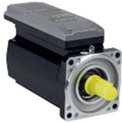
Das innovative Lexium 62 ILM vereint Motor, Leistungsendstufe und den digitalen Servoregler für eine Achse in einem platzsparenden Gehäuse. Aufgrund der kompakten Bauweise mit integrierter Steuerung eignet er sich hervorragend für einen dezentralen Aufbau. Er ist mit Single- oder Multiturnggeber lieferbar und konfiguriert sich mit Hilfe des elektronischen Typenschildes im Lexium 62 ILM selbst.
