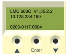
Zusätzlich zu den LED-Anzeigen erhalten Sie über das 4-zeilige Liquid Crystal Display (LCD) weitere Informationen zum Betriebsstatus der Steuerung.
