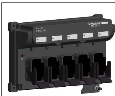
Die Lexium 62 Distribution Box ist das Bindeglied zwischen Lexium 62 Connection Module und Lexium 62 ILM. Je nach Anzahl der Antriebe können wahlweise 1 bis 4 Lexium 62 ILMs bzw. Daisy Chain-Stränge angeschlossen werden. Beim Betrieb von mehr als vier Antrieben erweitern Sie das System einfach durch ein oder mehrere Lexium 62 Distribution Box.
