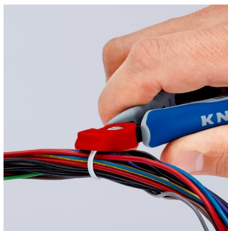
Elimine la parte superior de la brida de cable con el alicate de corte diagonal para electrónica...
