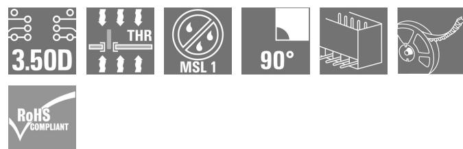
Hochtemperaturfeste, zweireihige Stifteleiste für alle gängigen Lötverfahren. Optimiert für die Automatenbestückung. Verpackung in Box oder Tape. Stiftlänge 3,2 mm für Reflow- und Wellenlötanwendungen geeignet. Die Stifteleisten bieten Platz für Beschriftungen und können kodierte werden.
