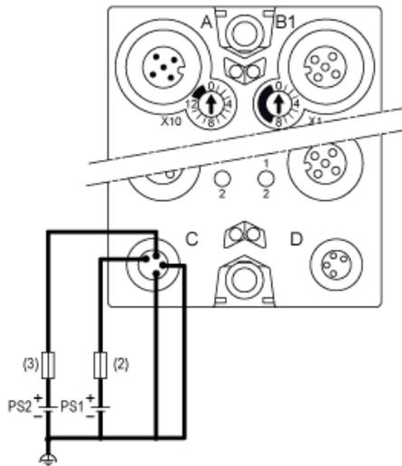
(2) Fusibile esterno tipo T ad azione lenta 1 A, 250 V <sup>1</sup>
