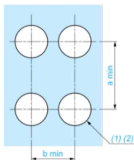
(1) Durchmesser auf fertiger Schalttafel oder Montagehalterung
