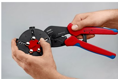
Cambio de la mordaza de crimpado: desbloquear la posición del almacén, extraer la mordaza de crimpado del alicate
