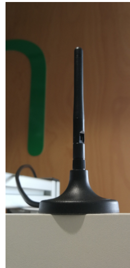
Modulantenne außerhalb des Schaltschranks
