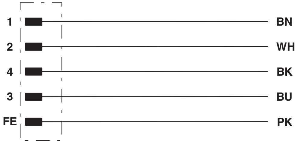
Affectation des contacts du connecteur mâle M12
