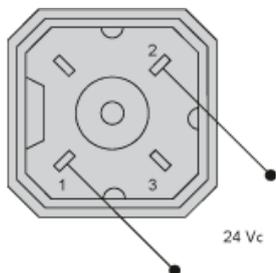
El conector se incluye con el pedido. Designación del conector: tipo Hirschmann G4 A 5M
