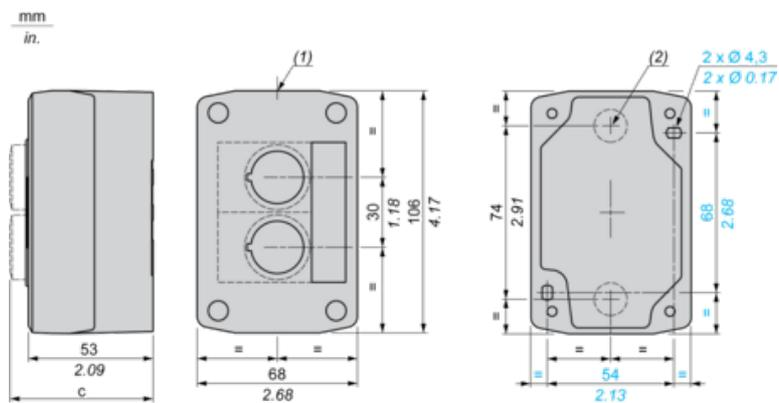
(1) 2 prerrecortes para prensaestopas Pg 13.5, capacidad máxima 12 mm (0.47 in)
