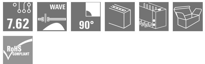
Einreihige Hochstrom- und High Performance Stiftleisten, polverlustfrei anreihbar oder mit Flansch zur schnellen, werkzeuglosen Verriegelung. Höchste Bedienungs- und Betriebssicherheit durch 100% fehlstecksicheres Steckgesicht, einzigartige Kodiervielfalt und Zusatzbefestigung im Flansch.
