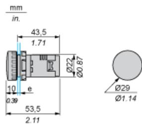
e Spessore pannello di supporto: da 1 a 6 mm/da 0.4 a 0.24 in. (metallo), da 2 a 6 mm/da 0.8 a 0.24 in. (plastica).
