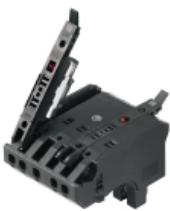
Energieverteilung mit ungeschnittener Leitung mit Leitungsquerschnitten von 1,5 bis 6mm<sup>2</sup>. Einspeisung / T-Abzweig über PUSH IN Anschluss 0,5 bis 10 mm<sup>2</sup> und/oder Steckanschluss 0,5 bis 4mm<sup>2</sup>. Farbige Markierungen ermöglichen eine eindeutige Leiterzuordnung.
