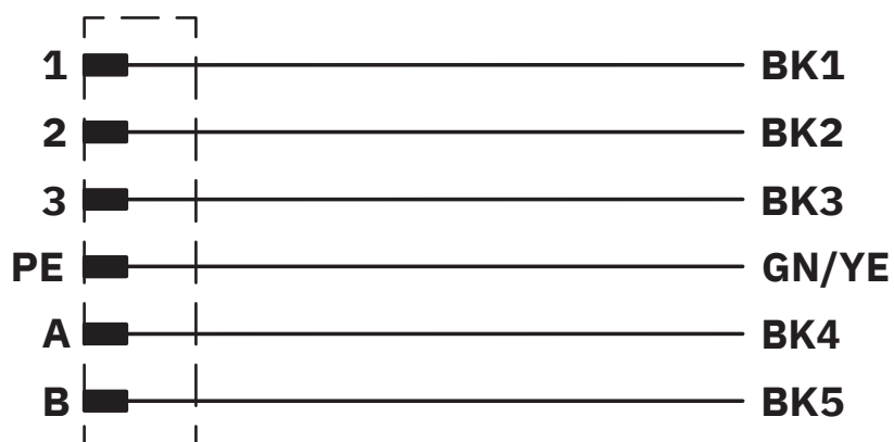
Asignación de contactos del conector hembra S15
