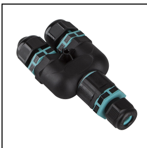
310495 Abzweigdose Y 3-WEGE Ø 14-17 mm IP 68
