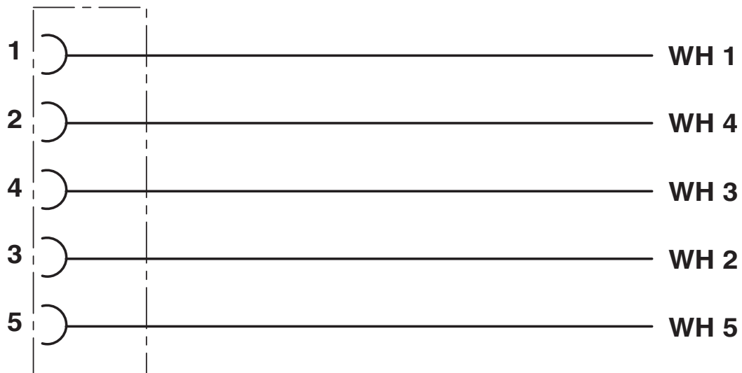
Kontaktbelegung der M12-Buchse
