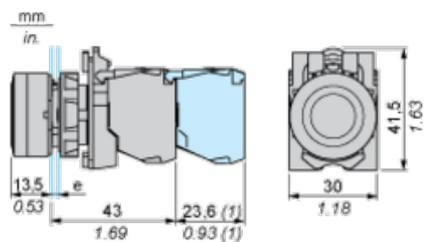
e: espesor de sujeción: de 1 a 6 mm (de 0.04 a 0.24 in)
