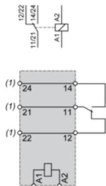
(1) Los terminales 11 y 21, 14 y 24, y 12 y 22 deben estar conectados para estos modelos.
