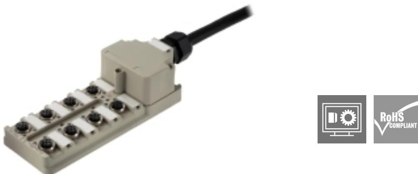
M12 Verteiler werden in allen möglichen Ausführungen angeboten. Die 4,6 oder 8 M12 Steckplätze sind 4 oder 5 polig. Der Sammelabgang ist wahlweise ausgeführt als Festkabelvariante, Haubenvariante zum Selbstanschließen oder mit M23. Weiterhin gibt es einige besondere Ausführungen. So gibt es 1 zu 1 Verteiler für die freie Wahl der Anschlüsse oder auch Verteiler, die für die Ex Zone 1 zugelassen sind.
