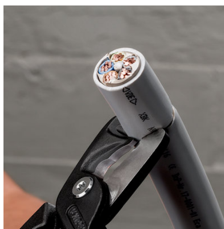
Testa affusolata per una migliore accessibilità
