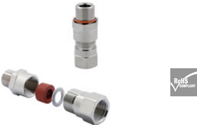
Kabelverschraubungen des Typs A2LC sind für nicht armierte Kabel geeignet und verfügen über ein Rohranschluss-Innengewinde, wobei der Explosionsschutz Ex d und Erhöhte Sicherheit Ex e erhalten bleibt.
