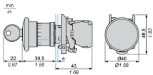
e: espesor de sujeción: de 1 a 6 mm (de 0.04 a 0.24 in)
