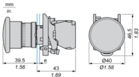
e : épaisseur du dispositif de serrage : 1 à 6 mm / 0,04 à 0,24 pouce
