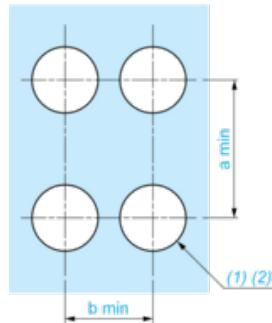
(1) Diamètre sur support ou panneau réalisé
