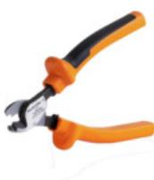
Schneidwerkzeuge für Leiter bis 8 mm, 12 mm, 14 mm bzw. 22 mm Außendurchmesser. Die spezielle Schneidengeometrie ermöglicht ein quetschfreies Schneiden von Kupfer- und Aluminiumleitern mit minimalen Handkräften. Zudem besitzen die Schneidwerkzeuge (KT 8 bis KT 22) VDE- und GS-geprüfte Schutzisolationen bis 1.000 V gemäß EN/IEC 60900.
